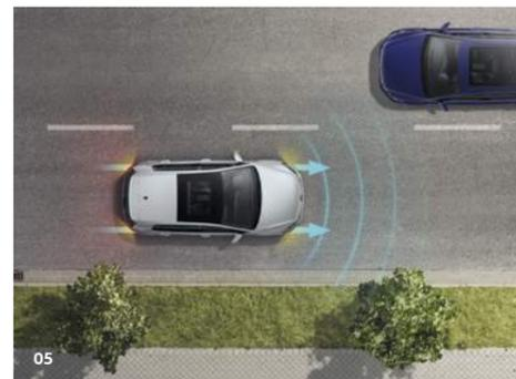
**01** Assurez votre sécurité mais aussi celle des autres : Le **système de surveillance périmétrique 'Front Assist' avec fonction de freinage d'urgence en ville et détection des piétons** peut aider à réduire les dégâts causés par un accident imminent ou, dans l'idéal, à éviter l'accident. Il détecte les piétons et les autres obstacles sur la chaussée et avertit le conducteur à temps.<sup>1)</sup> En l'absence de réaction de ce dernier, le véhicule déclenche un freinage d'urgence. De série.
