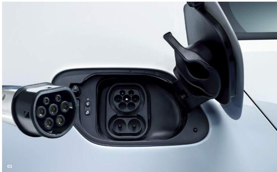
**01 | 02** Grâce au système de recharge CCS (Combined Charging System) vous pouvez recharger 80% de votre batterie en 45 minutes, dans les stations de recharge rapide (DC 40 kW).
