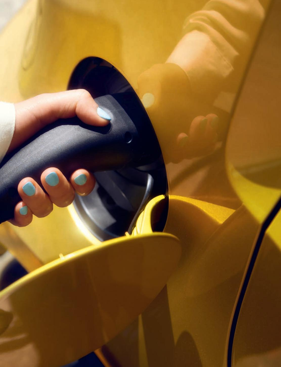
**01-02** Grâce au système CCS (**Combined Charging System**), seule une prise de recharge est nécessaire pour recharger la Nouvelle e-up! de deux manières : avec du courant alternatif via le câble de recharge pour prise secteur, les stations de recharge et la borne de recharge, ou avec du courant continu via des stations de recharge publiques équipées du système pour une recharge rapide.
