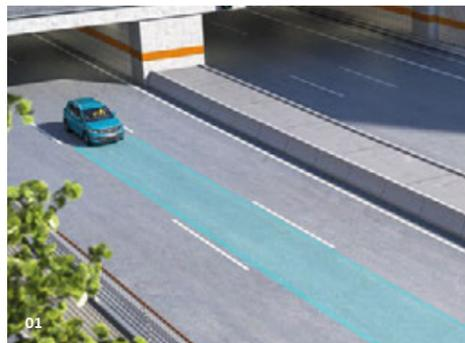
**01** L'assistant de maintien de trajectoire **'Lane Assist'** peut détecter, à partir de 60 km/h, si le véhicule quitte involontairement sa propre voie<sup>1)</sup> et corrige la trajectoire par une action sur la direction<sup>1)2)</sup>.
