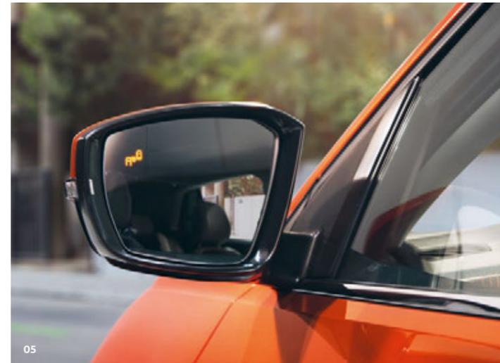
**05** Le détecteur d'angle mort **'Blind Spot'** vous avertit de la présence de véhicules dans l'angle mort grâce à des LED situées dans le rétroviseur concerné.<sup>1)</sup> Lorsque vous sortez d'une place de stationnement en marche arrière, l'assistant intégré surveille la zone située derrière votre véhicule et vous signale toute circulation transversale détectée.<sup>1)</sup>
