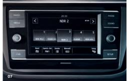
07 Le système "Composition Colour" est équipé d'un écran tactile TFT couleur de 16,5 cm (6,5 pouces) et de huit haut-parleurs pour une puissance en sortie de 4 x 20 watts, ainsi que l'un logement pour carte SD.
