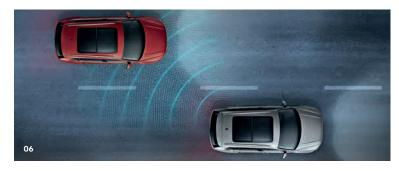
(visuel non présenté) Sécurité garantie : le freinage anti-multicollision déclenche le processus de freinage après une collision afin d'éviter, dans l'idéal, une collision en cascade<sup>1)</sup>.
