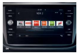
06 Le système "Composition Media" est doté d'un écran couleur TFT tactile avec détecteurs d'approche de 20,3 cm (8 pouces) et d'un lecteur CD pouvant lire les fichiers MP3 et WMA. Les huit haut-parleurs, d'une puissance en sortie de 4 x 20 watts, vous offrent une expérience multimédia complète. Il est également pourvu d'un logement pour carte SD, d'une interface USB et d'une connexion Bluetooth® pour téléphones portables.
