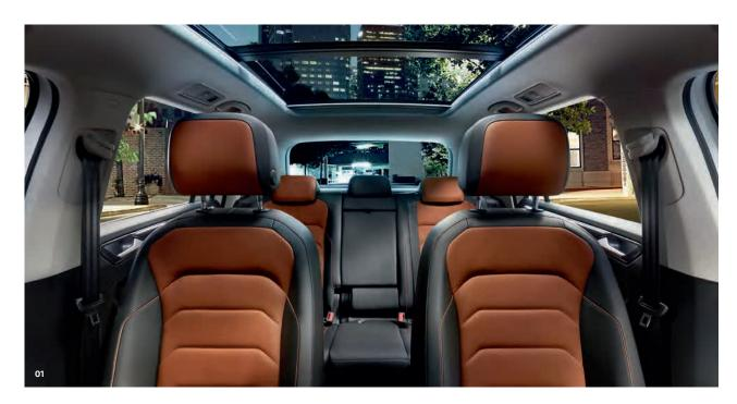
**01** Le **système de sièges modulables** permet de rabattre le dossier de tous les sièges passagers. De plus, la banquette arrière asymétrique peut être déplacée dans le sens longitudinal. De série dès Confortline.
