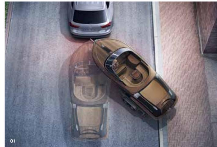
**01** Grâce au dispositif d'attelage, le Nouveau Tiguan Allspace tracte sans problèmes les remorques ou caravanes d'un poids pouvant atteindre 2,5 tonnes<sup>2)</sup>. L'assistant de manœuvre avec remorque "Trailer Assist" facilite les manœuvres de stationnement. Vous n'avez qu'à définir le sens de la marche et l'assistant pilote votre véhicule en marche arrière jusqu'au point final. Il vous suffit d'appuyer sur les pédales d'accélérateur et de frein et de surveiller les alentours<sup>1)</sup>.
