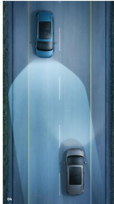
**04** Le système de régulation dynamique des feux de route 'Dynamic Light Assist' vous permet, à partir d'une vitesse de 60 km/h, de rouler en feux de route sans pour autant éblouir les usagers circulant en sens inverse.<sup>1)</sup> Une caméra peut détecter les véhicules qui précèdent ou qui viennent en sens inverse et bloquer les zones de lumière correspondantes.<sup>1)</sup> Le 'Dynamic Light Assist' est présent dans le Pack 'Drive Assist II' ou le Pack 'LED directionnels'.
