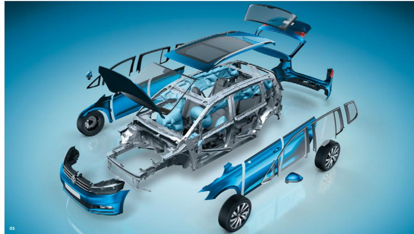
**05** Avec les airbags latéraux arrière en option pour la deuxième rangée de sièges, le Touran peut disposer sur demande de neuf airbags et ainsi, de protections optimales contre les blessures. En cas de collision, un airbag se gonfle dans un délai compris entre 35 et 45 millisecondes, en fonction de la violence du choc. Les airbags activés protègent la tête et le buste et répartissent les charges sur la plus grande surface possible.
