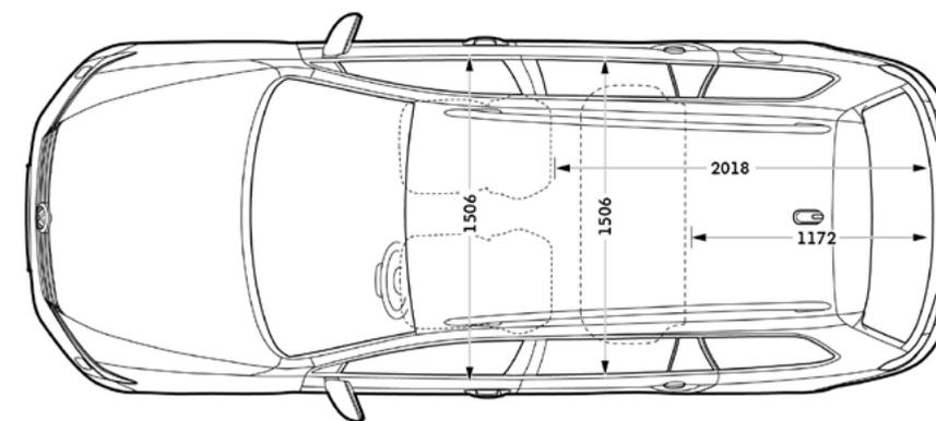
Sur les illustrations, lorsque les flèches et les chiffres sont montrés à l'intérieur du véhicule, les mesures sont pour les dimensions intérieures. Lorsque les flèches et les chiffres sont montrés à l'extérieur du véhicule, les mesures sont pour les dimensions extérieures.
