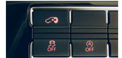
Portes coulissantes électriques
